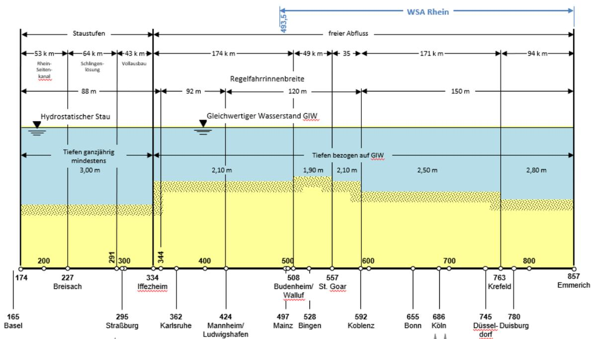
Figure 6 : Coupe longitudinale du Rhin (Source : WSV)
