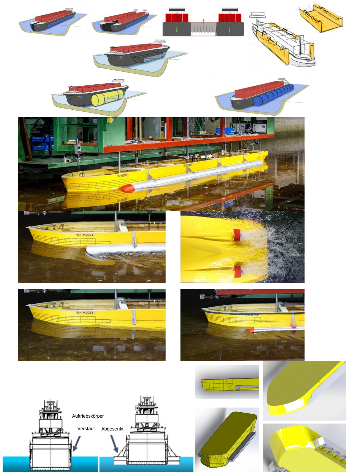
Abbildung 22: Erstes Konzept für zusätzlichen Auftrieb, geeignet für Neubauten und Nachrüstungen (Quelle: Novimove-Projekt)
