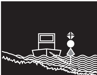
Artikel 3.26 Schepen, drijvende voorwerpen en drijvende inrichtingen waarvan de ankers een gevaar voor de scheepvaart kunnen vormen Lid 4: Anker van een drijvend werktuig.
