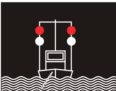
Art. 3.25 Engins flottants au travail et bâtiments échoués ou coulés ch. 1, lettre c: protection contre les remous ; passage libre des deux côtés
