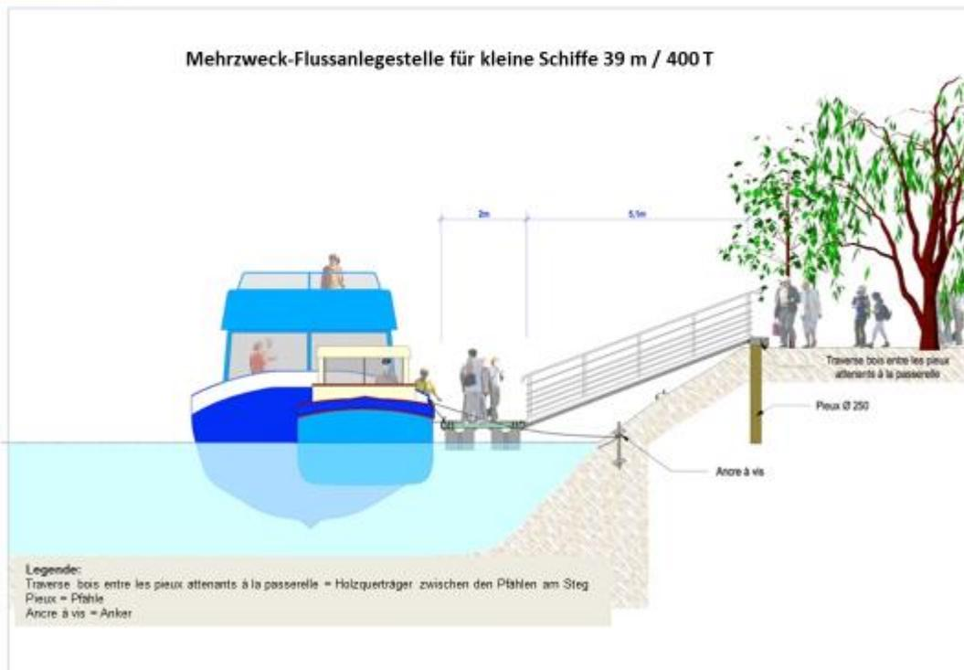
**VNF - KOSTENANSATZ - KAT 2 Mehrzweck-Anlegestelle für kleine Schiffe 39 m / 400 t / Tiefgang 2,50 m**
