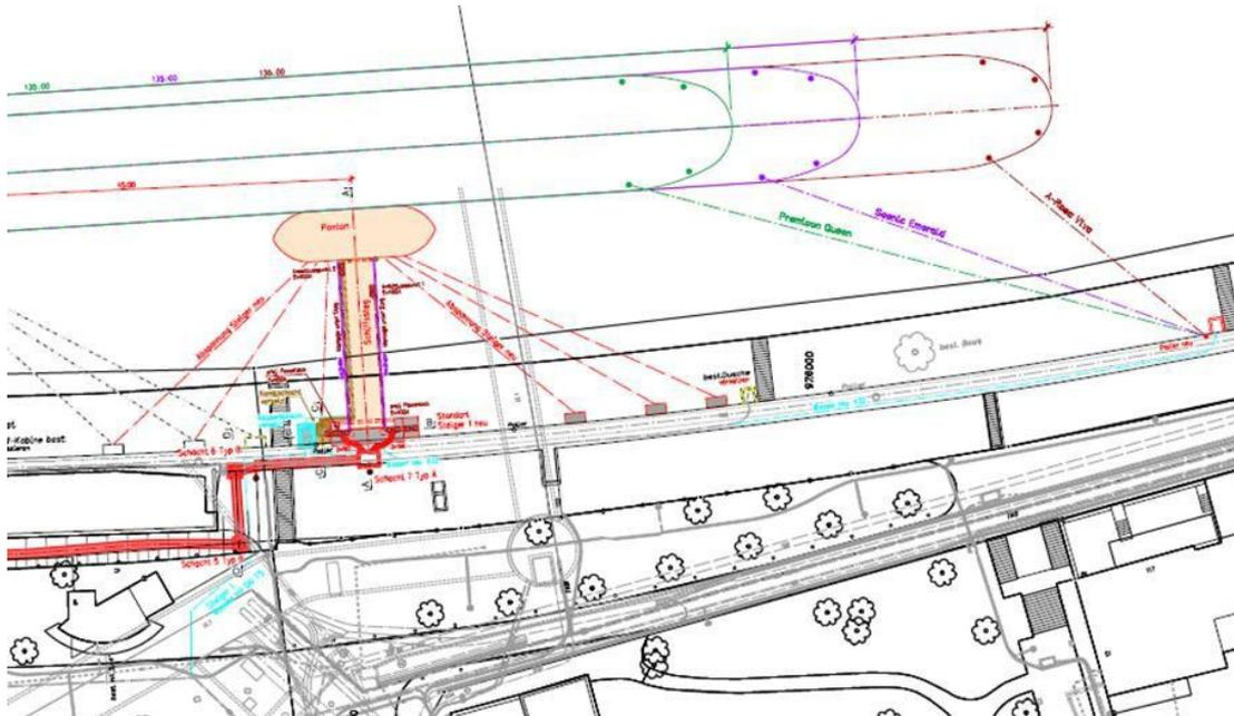
Standorte der Poller: Am Beispiel dieser drei 135-m-Fahrgastschiffe ist die unterschiedliche Anordnung der Haupteingänge in der Mitte des Pontons ersichtlich. Die Anordnung der Poller muss auf die Festmachmöglichkeiten an Bord ausgerichtet sein.
